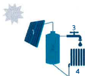
1. Zonnecollector | 2. Opslagvat zonneboiler | 3. Sanitair warm water | 4. Afrijft-element voor ruimteverwarming (optioneel)
