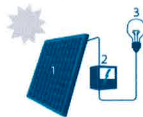
1. Zonnepaneel | 2. Omvormer | 3. Elektrische toestellen
